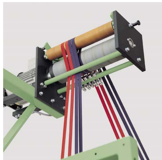
Drehmoment-gesteuerte Förderwalze für elastische Bänder oder sehr weiche Wicklungen
