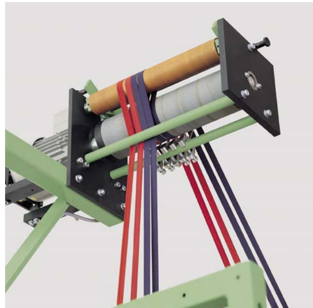
用于弹性窄幅织物的力矩控制输送辊或很柔软的卷绕
