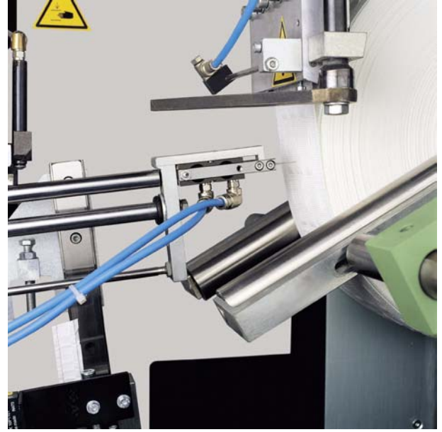
RAM-500 opsiyonu: Bant ucu sabitlemek için iğneli tertibat
