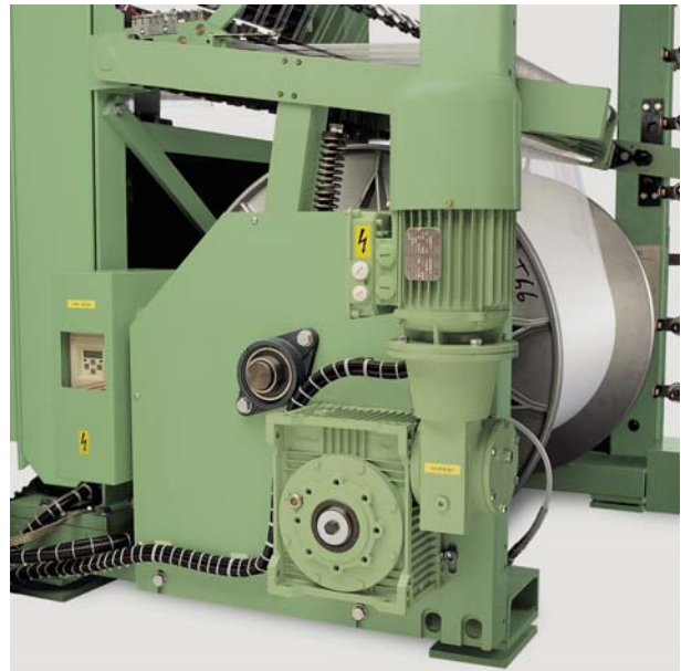
Elektronik çözümlü salma sistemi (DIGIKAST)
