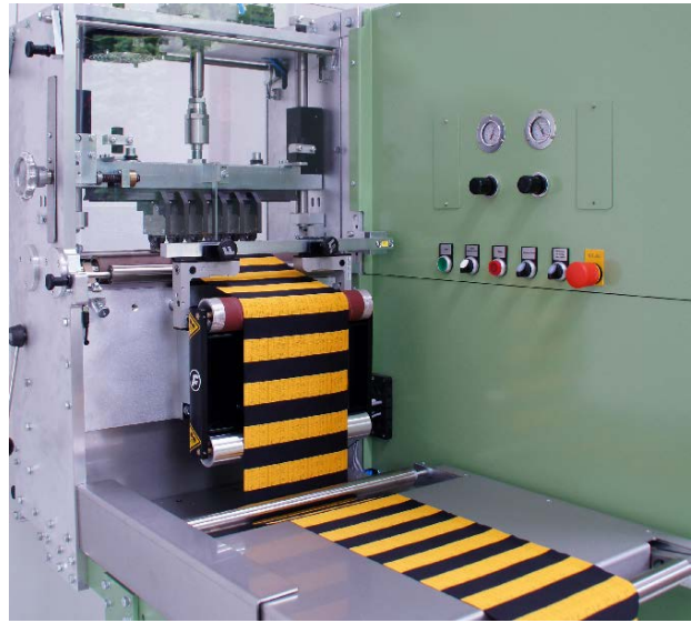
Besleme rulosundan etiket bandının makineye beslenmesi
