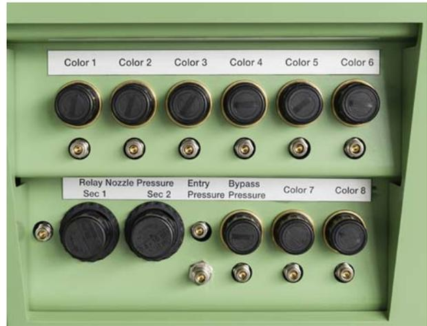
压缩空气控制装置
