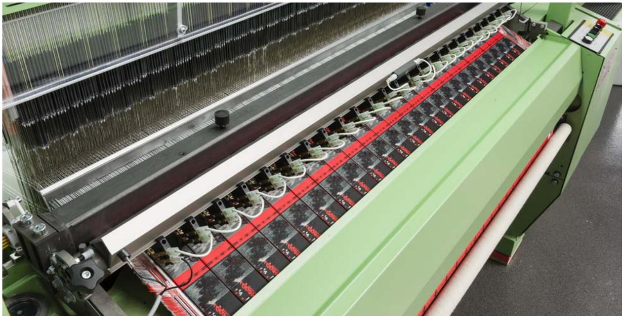
1,200 毫米工作宽度和 TC2 切割装置
