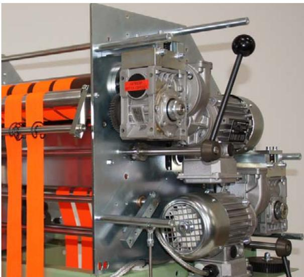
Separat gesteuerte Motoren für Ein- und Auslaufwalze
